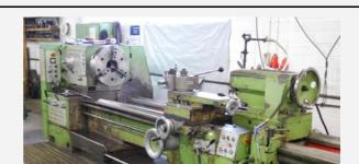
Heidenreich & Harbeck - Leit- u. Zugspindeldrehmaschine
